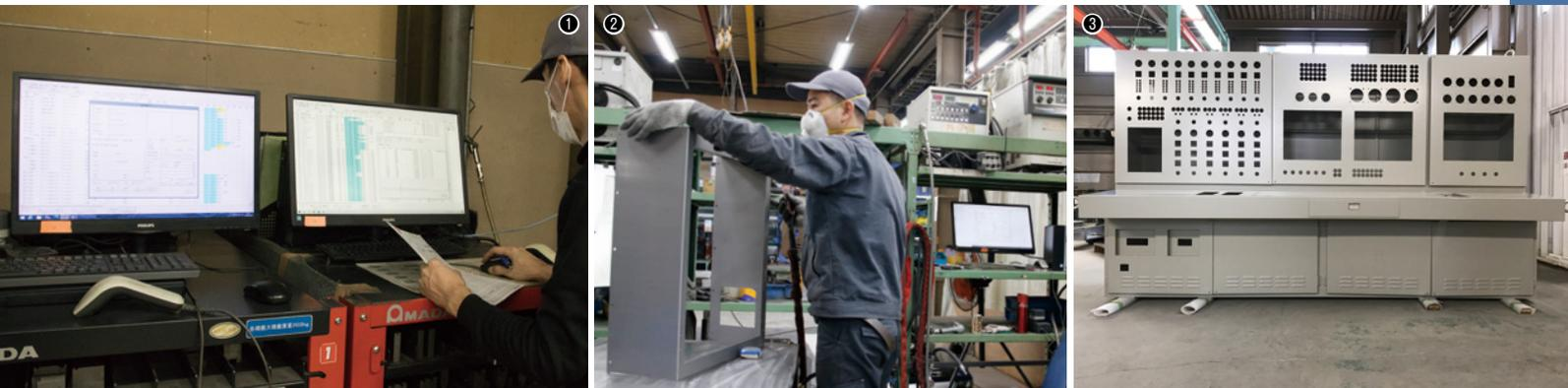
①現場では作業員1人につき1台ずつPC端末を設置。「着手」「中断」「再開」「完了」の情報を入力し、正確な「実績工数」を記録する／②溶接工程にもPC端末を設置。曲げ・溶接工程には50インチ級の大型ディスプレイを1人1台設置し、ペーパーレス化に対応する計画／③同社が製作した監視盤
