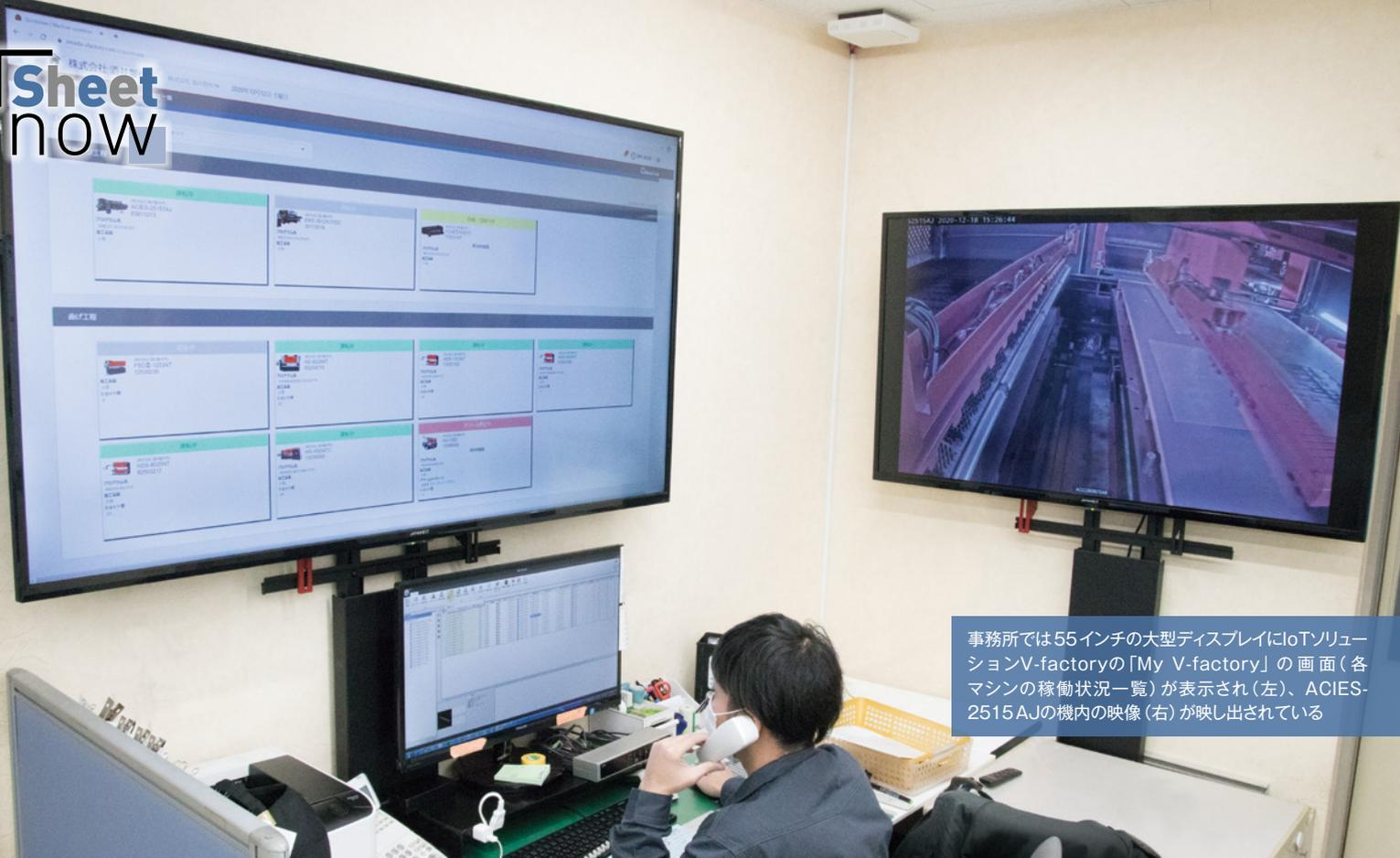
事務所では55インチの大型ディスプレイにIoTソリューションV-factoryの「My V-factory」の画面（各マシンの稼働状況一覧）が表示され（左）、ACIES-2515AJの機内の映像（右）が映し出されている
