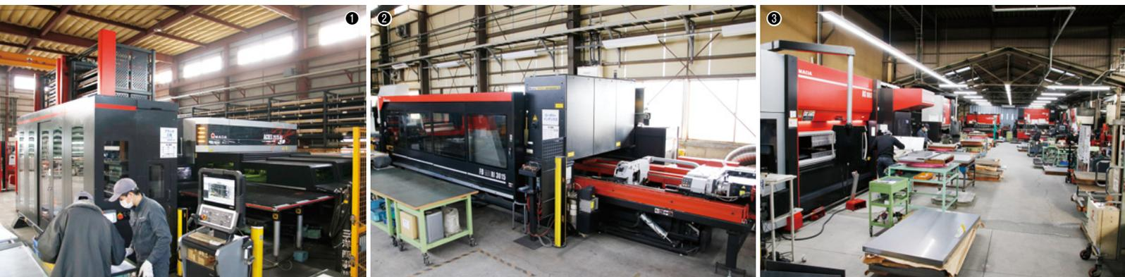
① ファイバーレーザ複合マシンACIES-2515 AJ。ブランク工程の生産性は2~3倍に改善した／② 平板・パイプ・形鋼兼用レーザマシンFO-MI RI3015。パイプ・形鋼は、特殊な形状や穴あけの加工に対応する／③ 曲げ工程。ベンディングマシン9台を設備し、長さ3mまでの曲げ加工に対応する
